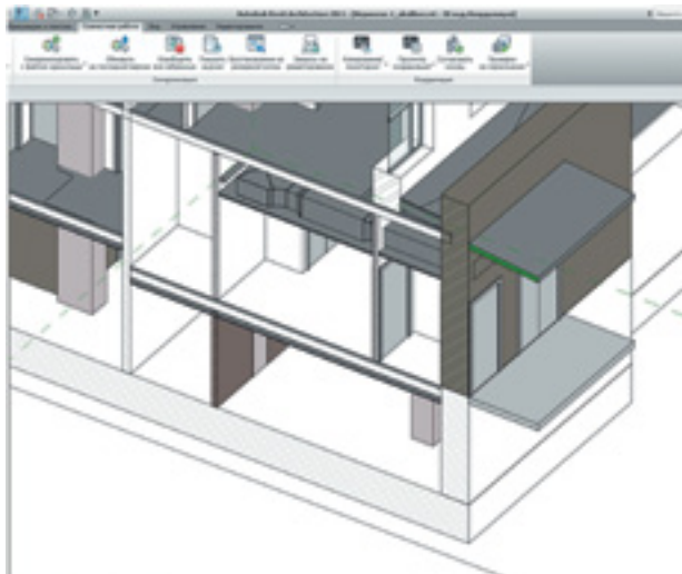
Рис. 12. Фрагмент координации разделов проекта в Revit Architecture с Revit MEP
