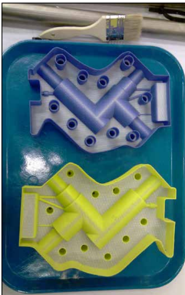
Рис. 3. Форма для литья, полученная по технологии с использованием трехмерного принтера
