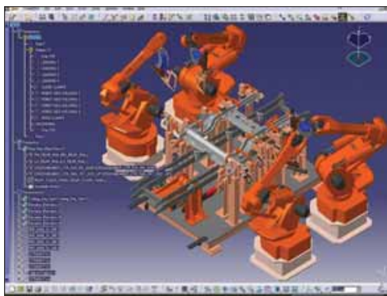
Рис. 11. Пример моделирования сборочной линии (рисунок Dassault Systemes, S.A.)
