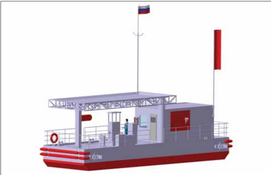
Рис. 8. Моделирование (на ранней стадии) процесса обслуживания ТРК на понтоне-заправке
