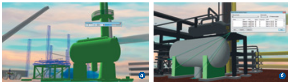
Рис. 3. Симуляция строительства (а); обнаружение коллизии (б)
